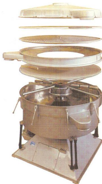
Construction circulaire avec une alimentation centrale du produit, positionnement variable des sorties, nettoyage aisé!
